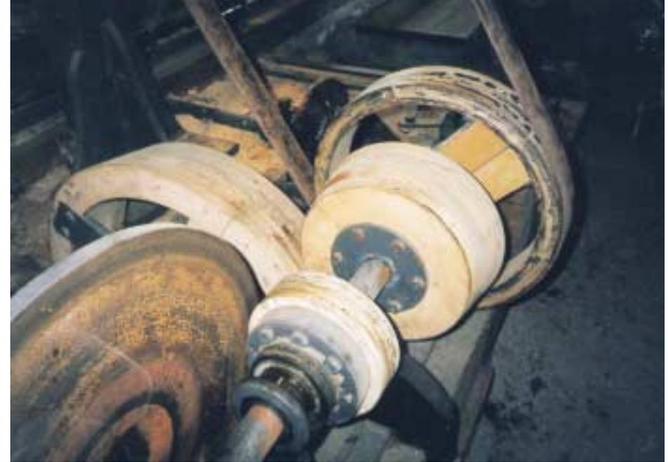
Detail der Blenhorster Sägemühle aus dem Jahr 1876: Mechanismus zur Geschwindigkeitssteuerung des Sägeschlittens und Holzrad mit Transmission.
