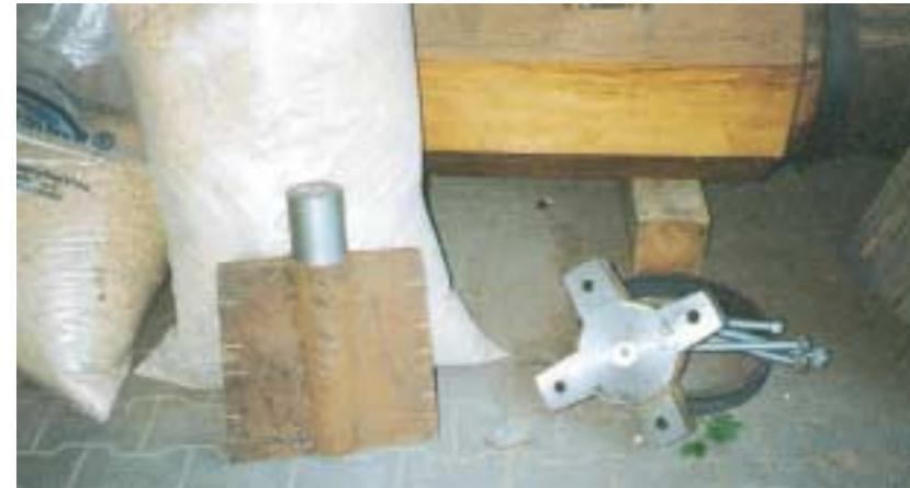
Links auf dem Bild ein Spatenzapfen, rechts ein Anschraubzapfen, dessen Kreuzteil an der Stirnseite der Welle eingepasst wird und danach mit vier Bolzen parallel zur Welle angeschraubt wird.
