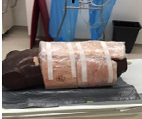
**Abb. 5: Fotografie des modifizierten, in Schweineschwarte eingewickelten Alderson - Rando - Phantom platziert auf einem Computertomographie - Tisch**
