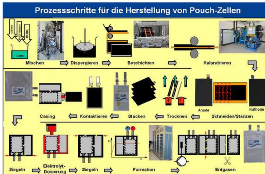
Abbildung 3.2: Prozessablauf des Bau von Pouchzellen [50]
