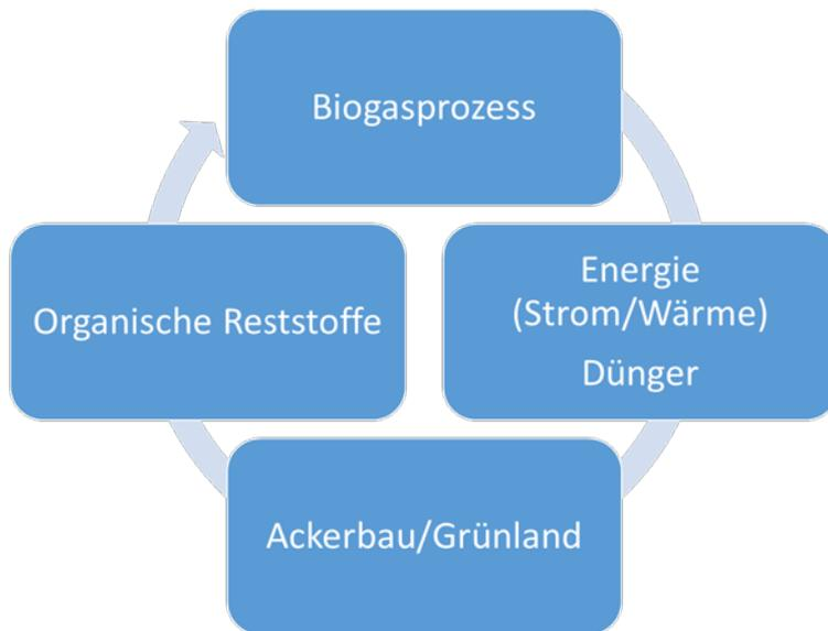
Abbildung 50: Stoffkreislauf bei Verwertung organischer Reststoffe in Biogasanlagen
