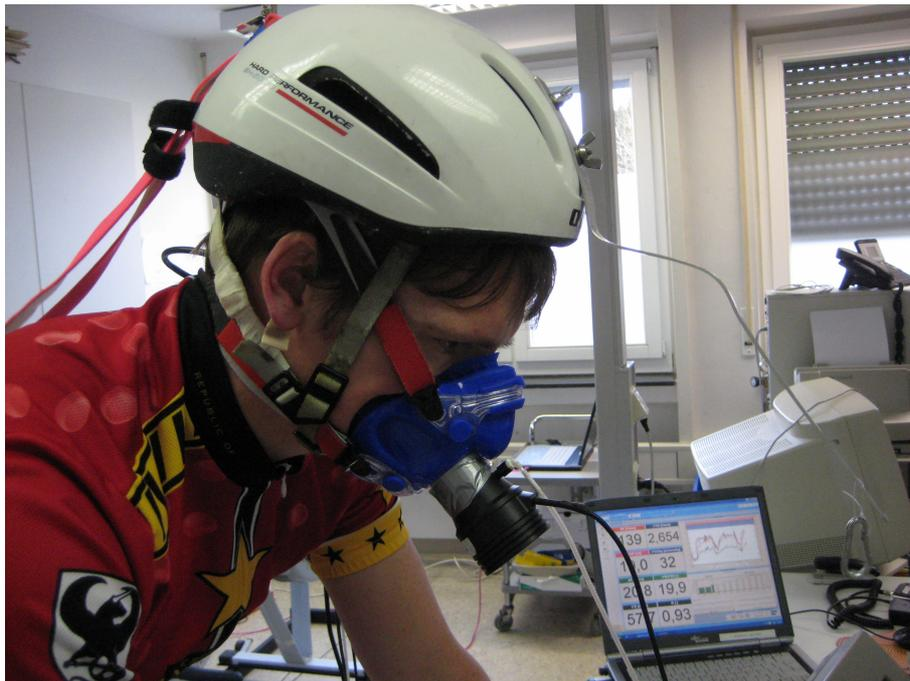
**Abbildung 10: Messphase ohne Y-Ventil auf dem Radergometer.** Untersuchung zur Validität der tragbaren Spiroergometriesysteme Cortex MetaMax 3b und 3x auf Ruder- und Radergometer am Universitätsklinikum Ulm von 2010 - 2012.
