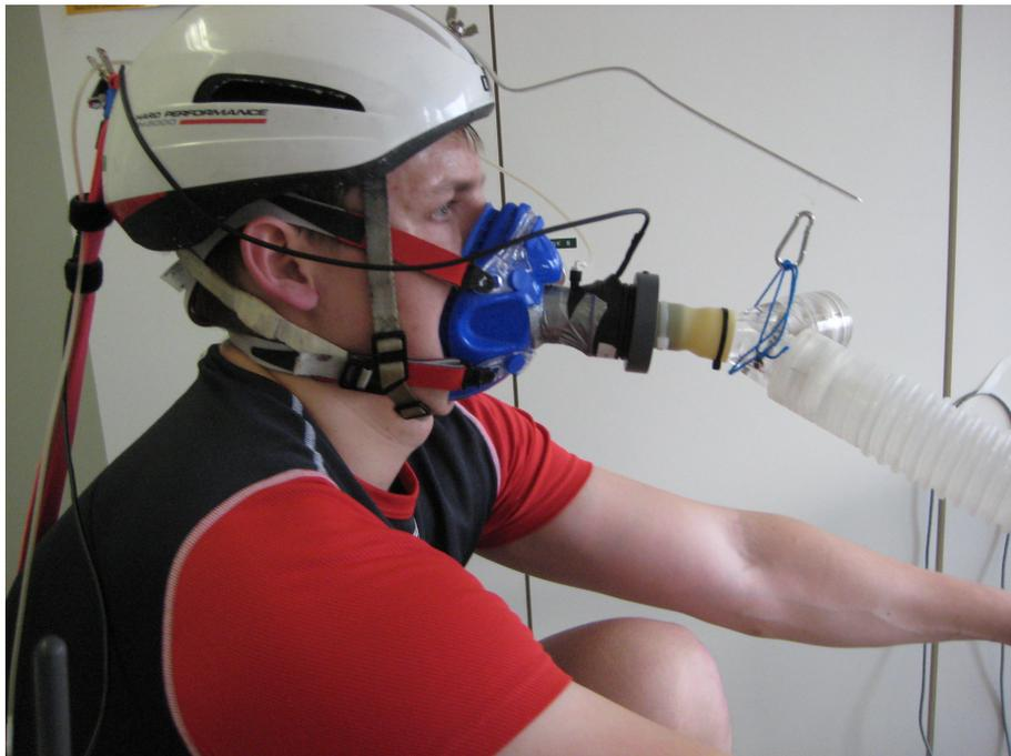
**Abbildung 9: Messphase mit angeschlossenem Y-Ventil auf dem Ruderergometer.** Untersuchung zur Validität der tragbaren Spiroergometriesysteme Cortex MetaMax 3b und 3x auf Ruder- und Radergometer am Universitätsklinikum Ulm von 2010 - 2012.
