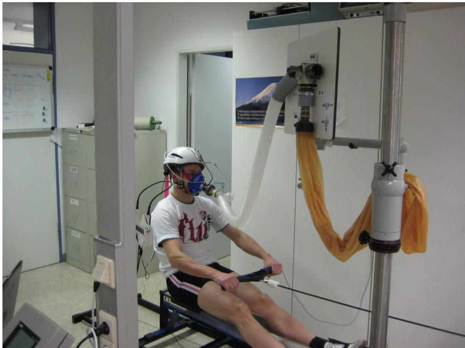
**Abbildung 7: Versuchsaufbau bei der Douglas-Bag-Messung.** Untersuchung zur Validität der tragbaren Spiroergometriesysteme Cortex MetaMax 3b und 3x auf Ruder- und Radergometer am Universitätsklinikum Ulm von 2010 - 2012. Der Proband ist mit einem großlumigen Schlauch über einen 3-Wege-Hahn mit dem Douglas-Bag verbunden.
