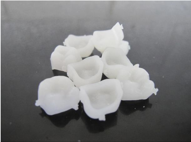
**Abbildung 8:** Aus einem Wachsblank durch CAD/CAM gefräste Wachskronen vor der Nachbearbeitung zur Herstellung der Lithiumdisilikatkronen
