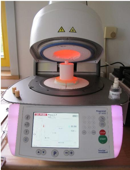
**Abbildung 10:** Pressen des Rohlings in die Muffeln im Presskeramikofen zur Herstellung der Lithiumdisilikatkronen
