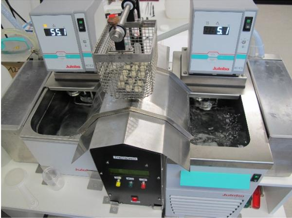
**Abbildung 20:** Thermozykliegerät mit eingelegten und auf die Prüfstümpfe zementierten Kronen, welche über einen Schwenkarm vom 55°C (Grad Celsius) warmen ins 5°C kalte Wasserbad befördert werden
