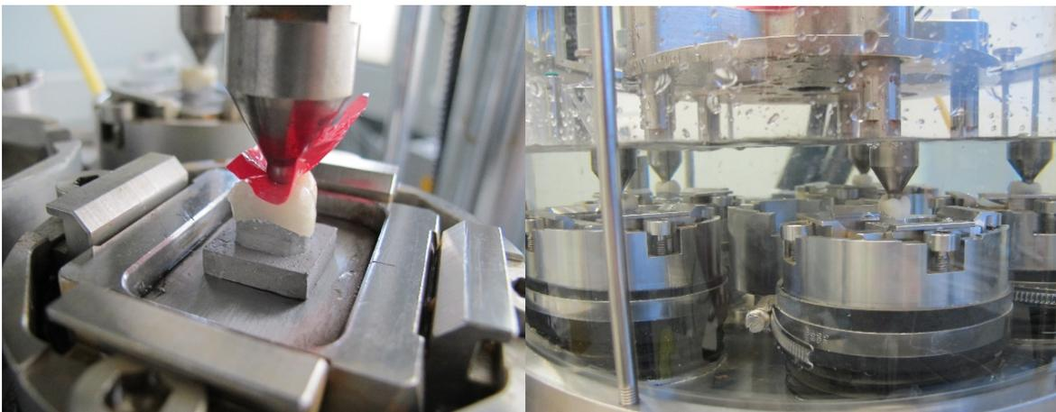
**Abbildung 22:** Justierung der Proben im Kausimulator, die Position wird mit Okklusionsfolie kontrolliert, nach anschließender Fixierung wird das Becken mit Wasser geflutet
