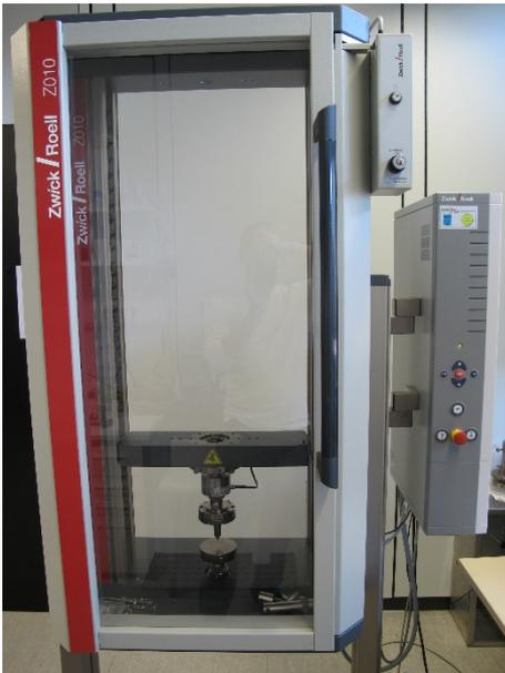
**Abbildung 23:** Universalprüfmaschine zur Aufnahme der auf die Stümpfe zementierten Kronen nach erfolgreich durchgeführter Kausimulation zur Belastung der Proben bis zum katastrophalen Bruch
