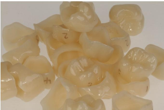
**Abbildung 13:** Fertiggestellte Kronen nach durchgeführtem Glanzbrand und Nummerierung
