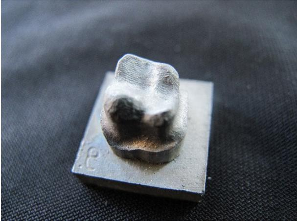
**Abbildung 4:** Einer der 30 fertiggestellten Metallprüfstümpfe nach gusstechnischer Herstellung und Ausarbeitung
