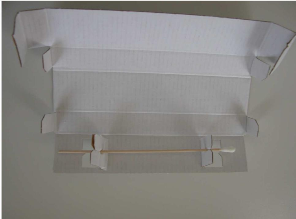
Abb. 15: Herkömmlicher Spureträger in Faltschachtel
