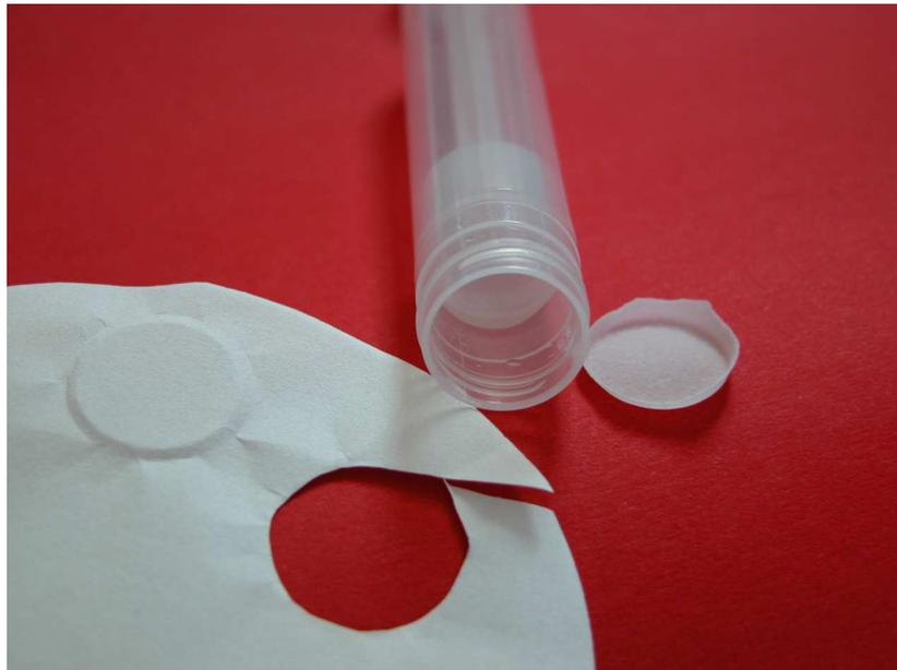
Abb. 21: Selbstgebaute Filtrationsvorrichtung
