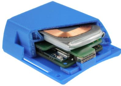
(a) Sensoreinheit v4.0 mit angeschnittenem Gehäuse und Blick auf Sensorplatine, Zusatzplatine mit Flexprintbuchse zum Anschluss des Satelliten, Akku und Induktionsladespule (von unten nach oben).
