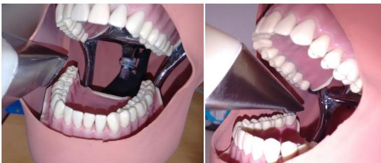
**Abb. 52:** Test intraoraler Zugänglichkeit mit einem Gehäusemodell des Intraoralscanners (IOS-Prototyp) an einem *frasaco* Phantomkopf. Die maximale Distanz der Schneidezähne wurde auf 40mm eingestellt. Links: Zugang zur bukkalen Oberfläche am dritten Molaren. Rechts: Zugang zur okklusalen Oberfläche am dritten Molaren.
