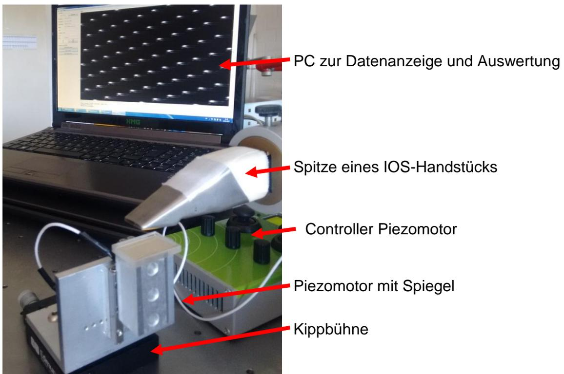
Abb. 15: Messplatz zur Kalibrierung des Intraoralscanners (Prototyp) und zur Evaluierung der Messgenauigkeit auf einer Spiegelprobe.
