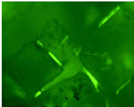
Abbildung 2.11: „Kapillarbrücken“ bei NaCl-Würfeln ( $W = 1\%$ ; vgl. Abbildung 1.15)
