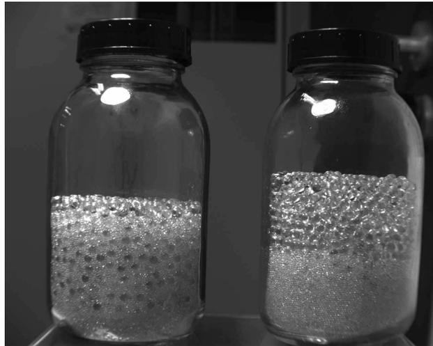
Abbildung 2.15: Segregation bei verschiedenen Flüssigkeitsanteilen  $W$
