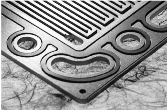
*Abbildung 2.7: Detailansicht einer Bipolarplatte aus Graphit-Komposit-Material mit eingelegerter Dichtung aus Viton*
