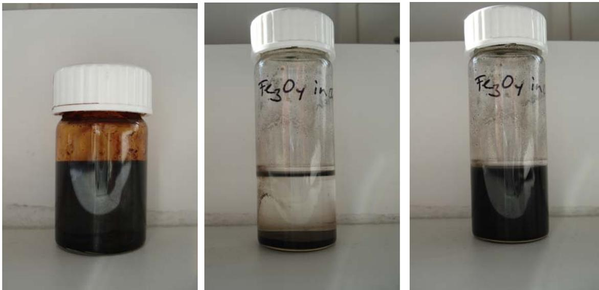
**Abbildung 4.25** Magnetitnanopartikel dispergiert in Octan. Links: 10 nm große Partikel sind stabil. Mitte und rechts: größere Partikel sinken ab, lassen sich jedoch wieder redispersieren.
