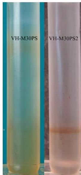
**Abbildung 4.27** Ultrazentrifugation von verkapselten Magnetitnanokristallen. VH-M30PS2 zeigt eine engere Dichteverteilung der Hybridpartikel.
