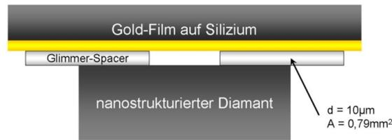
**Abbildung 4.12:** Schematische Darstellung der Versuchsanordnung für die Messungen in Diodenkonfiguration.
