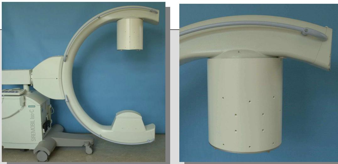
**Abbildung 6:** Fahrbarer ISO-C-Arm (links), Röntgendetektor mit leuchtdiodenbesetztes Schild (rechts)
