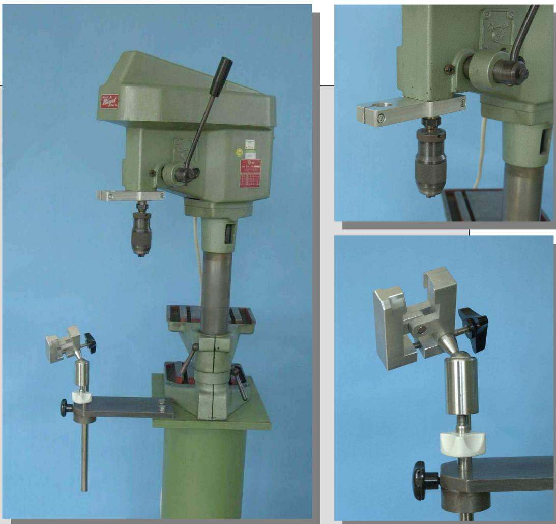
**Abbildung 5:** Komplettierte Bohrvorrichtung (links), Detail der Aufnahmevorrichtung für die „Kolibri“-Bohrmaschine (rechts oben), Halterung mit Kugelkopfarretierung für Kunststoffknochen (rechts unten)
