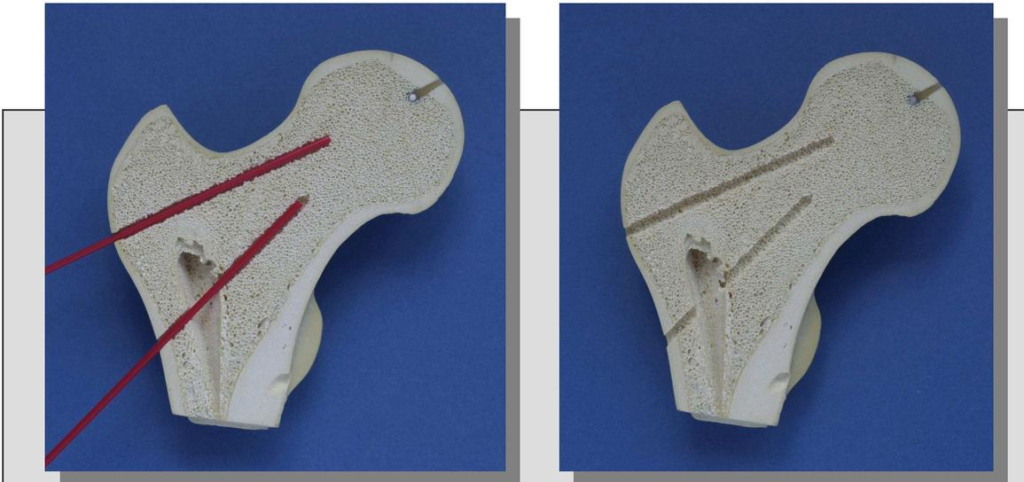
Abbildung 17: Überprüfung der Bohrkanallage am aufgeschliffenen Femurpräparat
