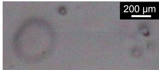
**Abbildung 5.44** Oberflächendefekte eines mit Ruß S160 pigmentierten Lackfilms in Form von Pinholes.
