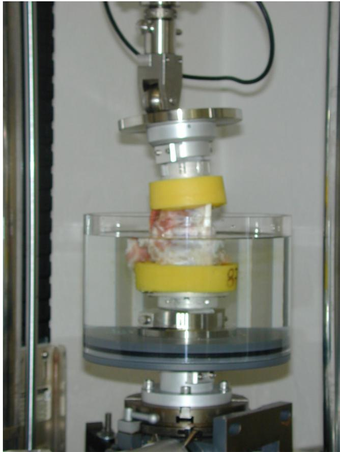
**Abbildung 20:** *Zyklische Dauerbelastung eines Wirbelsäulenbewegungssegments in der Instron 8871 mit Wasserbad.*
