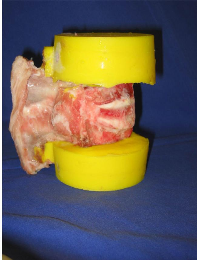
**Abbildung 3:** *Präpariertes und in Technovit eingegossenes lumbales Bewegungssegment.*
