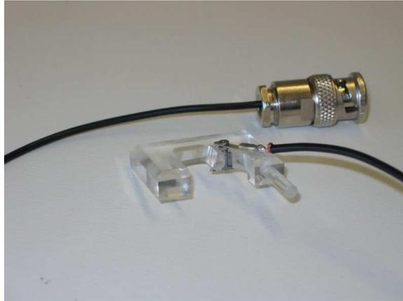
Abbildung 4.9.: Nachbau des Veeco Cantilever-Halters aus Plexiglas zur Kontaktierung des Cantilevers. Der Cantilever ist elektrisch isoliert zum restlichen Kopf.
