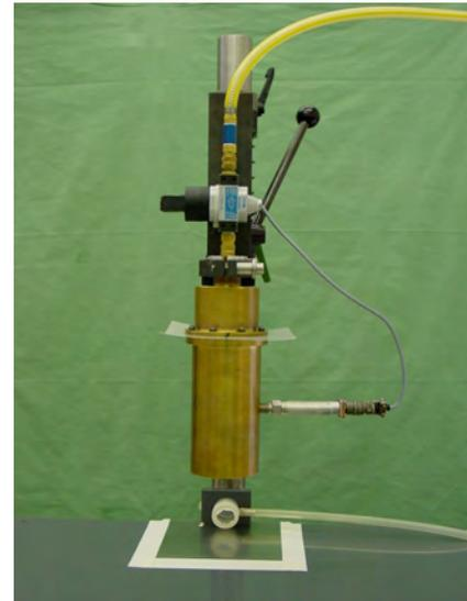
**Abb. 1:** Druckwellengenerator mit Druckerzeugungssystem und Druckmesssonde. Oberer und unterer Zylinder sind durch eine Mylarfolie voneinander getrennt, welche durch die druckbedingte Überschreitung der Berstspannung zerreißt. Somit konnte in Zentrierung über dem Thorax des Versuchstieres eine reproduzierbare Druckwelle erzeugt werden.
