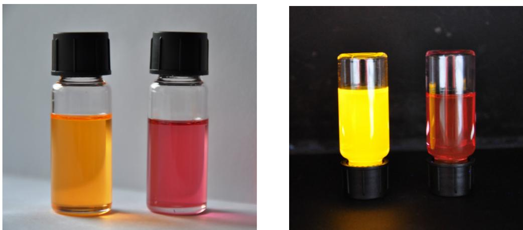
Abbildung 69: Thermochromie von [J-13T-J] in Lösung, linke Lösungen: heiß, rechte Lösungen: kalt.
