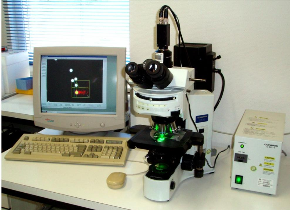
Abbildung 7: Fluoreszenzmikroskop mit CCD-Kamera und PC-Bildanalysesoftware zur Auswertung der mit Ethidiumbromid angefärbten DNA-Präparate
