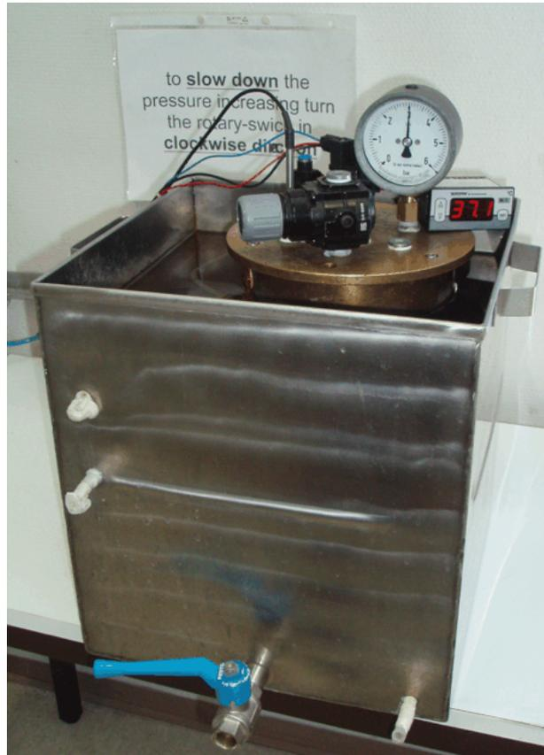
Abbildung 4: Druckkammer im Wasserbad zur Durchführung der HBO-Exposition
