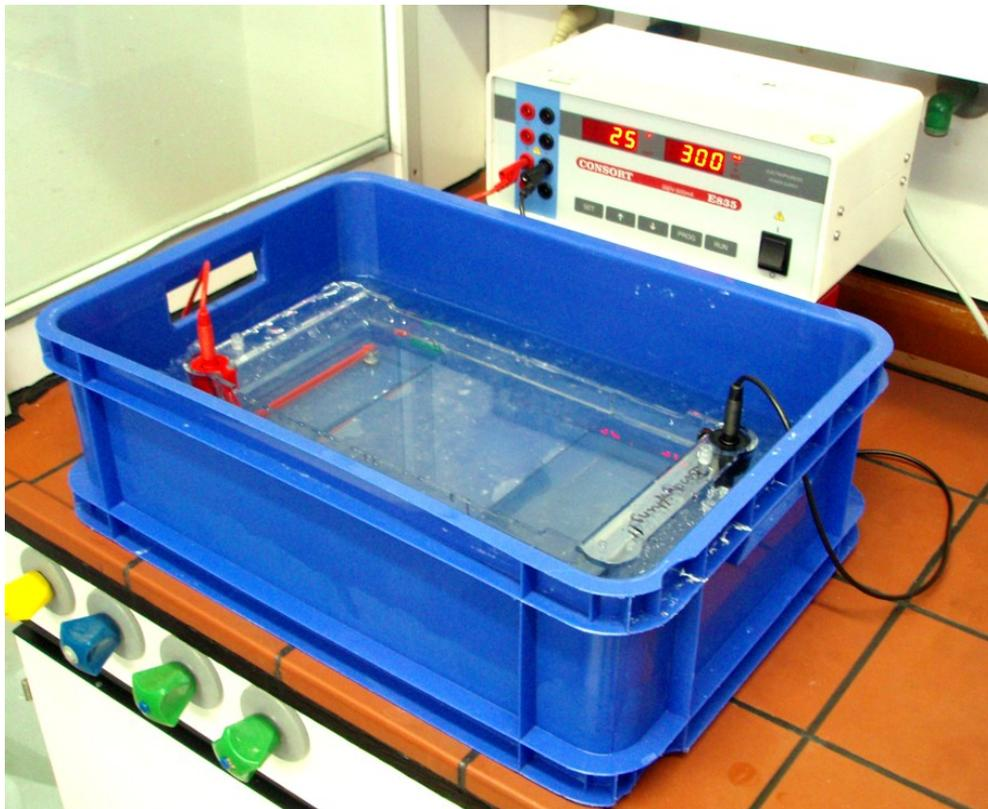
Abbildung 6: Elektrophoresekammer im Eiswasserbad zur Durchführung des Comet Assays mit Spannungsquelle im Hintergrund
