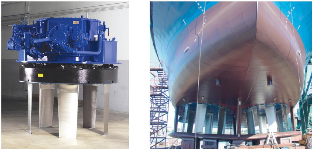
Abbildung 1.2: VSP (links), VSP am Schiffsrumpf (rechts) [14]
