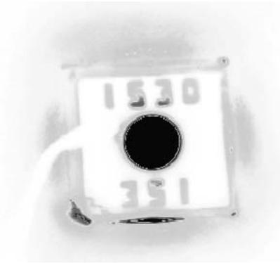
**Abbildung 5.4:** Invertierte Aufnahme eines VCSELs zur Bestimmung des Vergrößerungsfaktors des optischen Systems.
