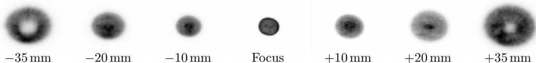
**Abbildung 5.2:** Sieben der insgesamt neunzehn Strahlprofile des VCSELS, aufgenommen mit der CCD-Kamera an verschiedenen Messpunkten relativ zum Fokuspunkt. Die Aufnahmen sind in Graustufen dargestellt, wobei dunkle Flächen höhere Intensitäten aufweisen.
