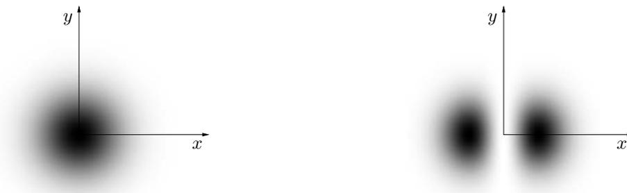
**Abbildung 3.6:** Berechnete Intensitätsprofile der Moden  $TEM_{00}$  (links) und  $TEM_{10}$  (rechts) dargestellt in Graustufen, wobei dunkle Flächen höhere Intensitäten aufweisen.
