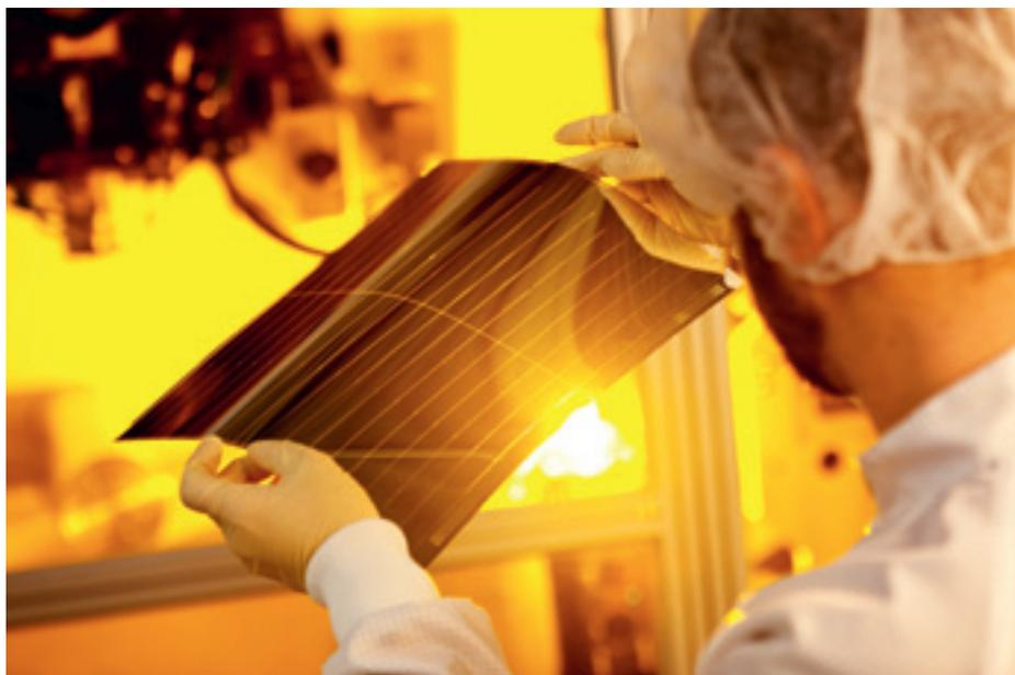
Qualitätskontrolle an der Produktionsanlage: Die organischen Solarzellen werden auf Polyester-Folien aufgedampft
