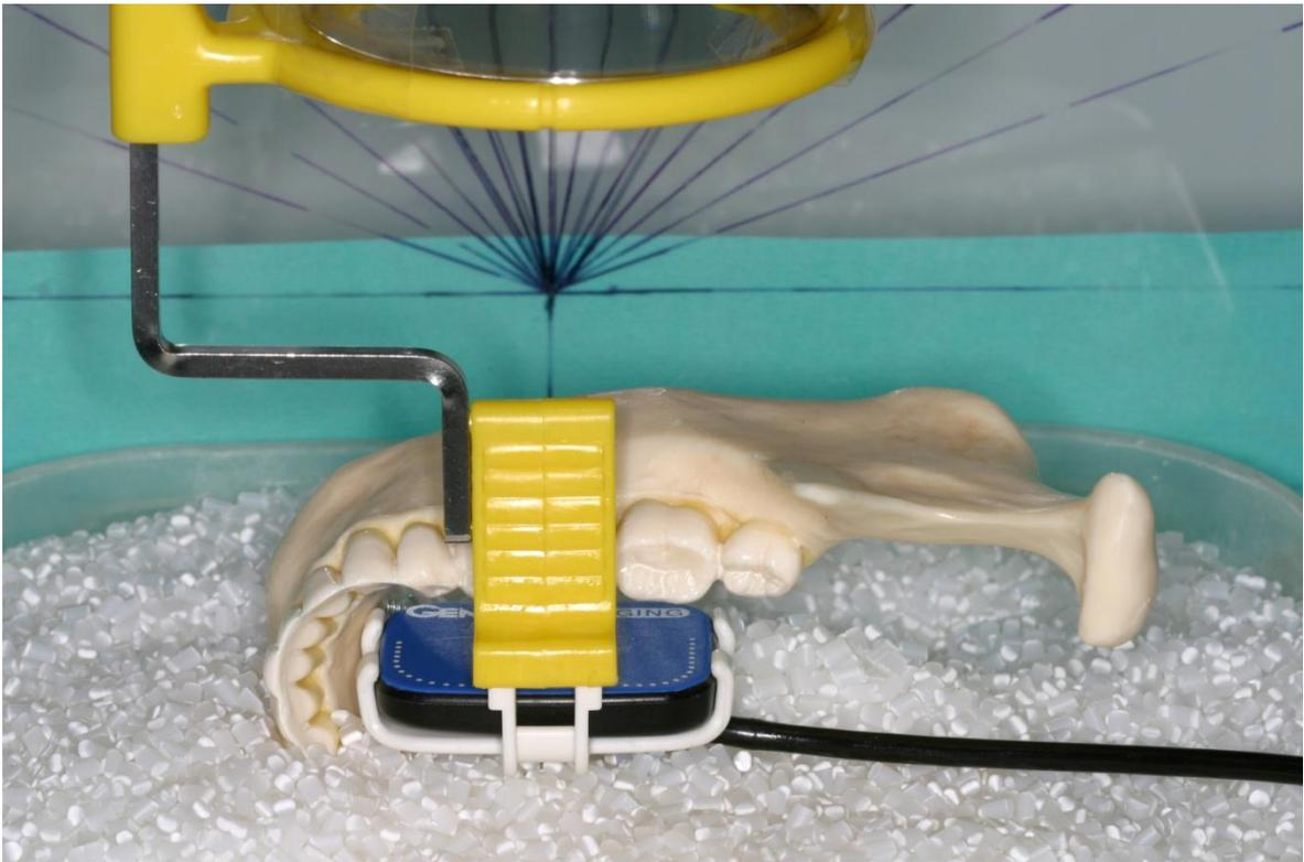
**Abbildung 4:** Schematische Detailansicht des Versuchsaufbaus mit Halter bei orthoradialer Röhrenangulation (die Zahnachse und der Sensor sind hierbei beide horizontal parallel ausgerichtet)
