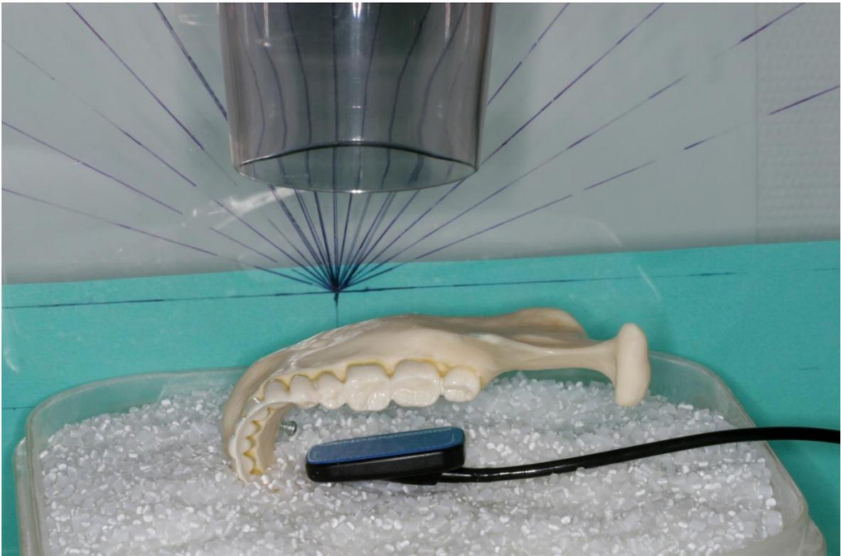
**Abbildung 6:** Schematische Detailansicht des Versuchsaufbaus ohne Halter bei orthoradialer Röhrenangulation (die Zahnachse und der Sensor sind hierbei horizontal parallel ausgerichtet)
