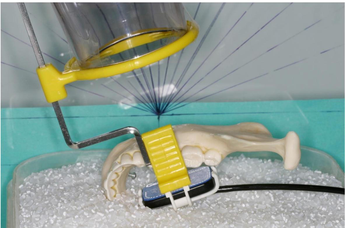
**Abbildung 5:** Schematische Detailansicht des Versuchsaufbaus mit Halter bei 20° mesialer Röhrenangulation (nur die Zahnachse bleibt hierbei horizontal parallel ausgerichtet)
