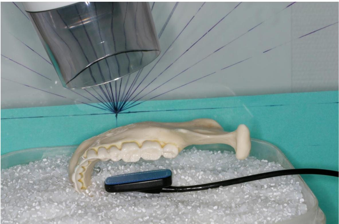
**Abbildung 7:** Schematische Detailansicht des Versuchsaufbaus ohne Halter bei 20° mesialer Röhrenangulation (die Zahnachse und der Sensor bleiben hierbei horizontal parallel ausgerichtet)
