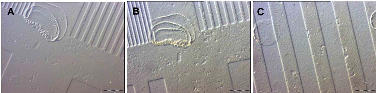
**Abbildung 151:** Lichtmikroskopische Aufnahmen eines mikrostrukturierten PMAA-Substrats vor (A) und nach Einlagerung mit Eisenoxidpartikeln (B, C; Bedingungen:  $1.9 \times 10^{-5}$  M  $\text{FeSO}_4^-$  und  $2.1 \times 10^{-5}$  M  $\text{Fe}_2(\text{SO}_4)_3$ -Lösung für 12 h).
