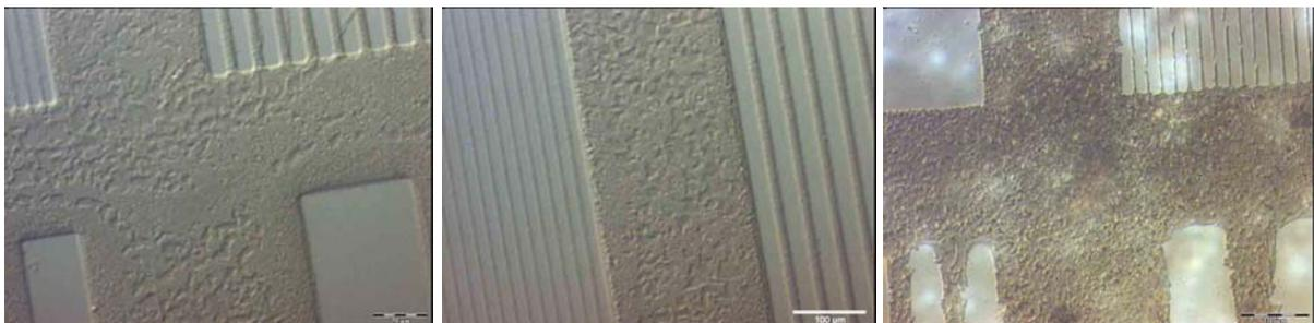
**Abbildung 129:** Lichtmikroskopische Aufnahmen einer PMAA/Bleisulfid-Probe hergestellt mittels 5 mM  $\text{Pb}(\text{NO}_3)_2$ - (12 h) und 10 mM  $\text{Na}_2\text{S}$ -Lösung (10 min).
