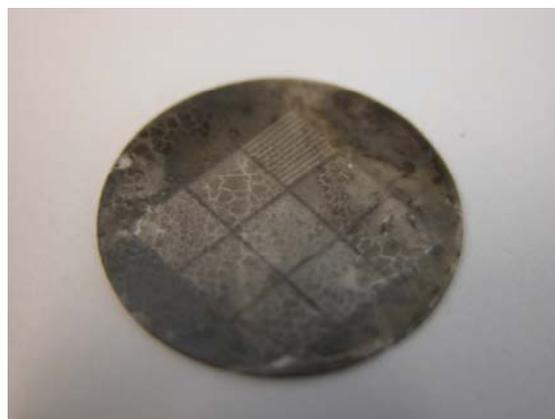
**Abbildung 134:** Foto einer mikrostrukturierten PMAA/Cobaltsulfid-Probe.
