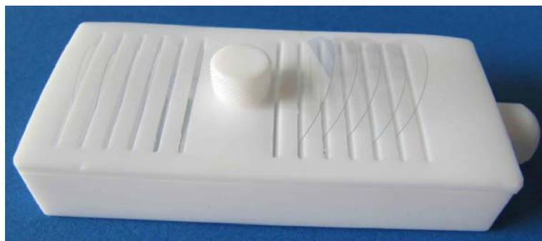
**Abbildung 29:** Reinigungsbehälter für Glassubstrate.
