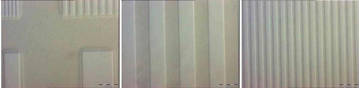
**Abbildung 145:** Lichtmikroskopische Aufnahmen eines mikrostrukturierten PMAA-Substrats mit Eisensulfidpartikeln (100 mM  $\text{FeCl}_2$  für 12 h und anschließendem Eintauchen in 10 mM  $\text{Na}_2\text{S}$ -Lösung für 2 min).
