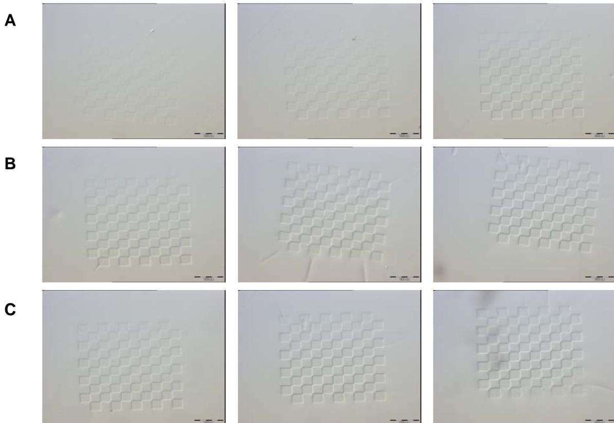
**Abbildung 36:** Lichtmikroskopische Aufnahmen mittels FIB strukturierter PMAA-Proben mit unterschiedlichen Bedingungen (Tabelle 2) auf ITO. Größenbalken: 100 nm.
