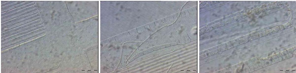
**Abbildung 116:** Lichtmikroskopische Aufnahmen einer mikrostrukturierter PMAA-Probe, eingelegt in eine 10 mM Zink- und Sulfidlösung.
