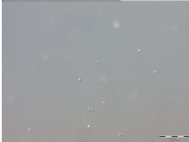
**Abbildung 17:** Lichtmikroskopische Aufnahme einer PMAA-Probe nach Belichtung direkt vor der Hamamatsu UV-Lampe.
