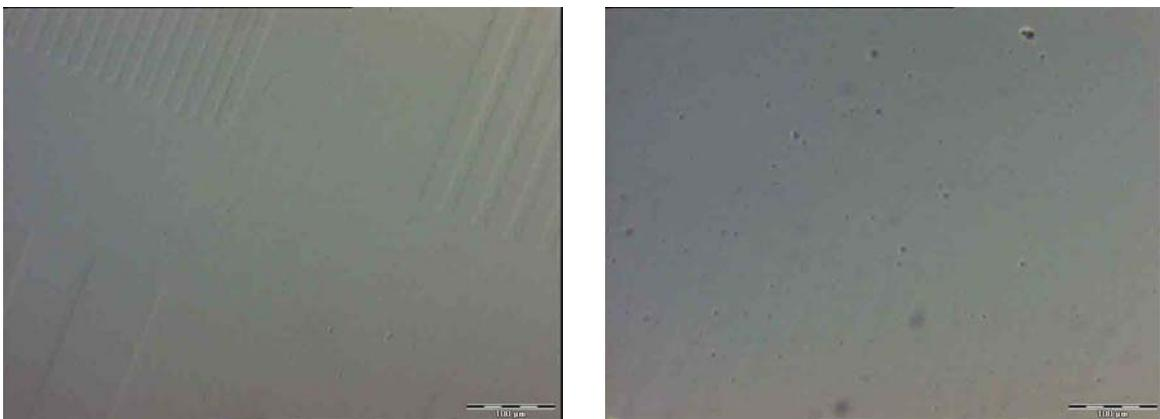
**Abbildung 173:** Lichtmikroskopische Aufnahmen mikrostrukturierter PMAA-Proben vor (links) und nach (rechts) Behandlung mit 100 mM ZnAc<sub>2</sub>-Lösung und (NH<sub>4</sub>)<sub>2</sub>CO<sub>3</sub>.
