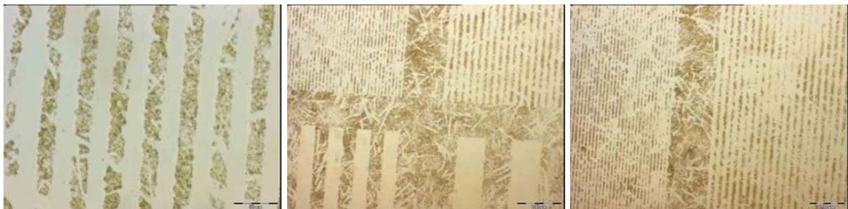
**Abbildung 97:** Lichtmikroskopische Aufnahmen einer CdS-imprägnierten PMAA-Probe nach 12 h.
