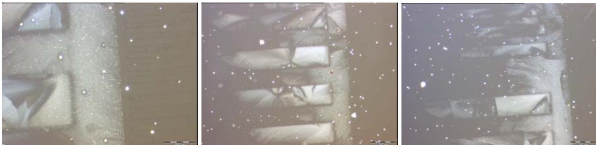
**Abbildung 67:**  $\text{CaCO}_3$ -mineralisierte PMAA-Probe M4 bei gekreuzt polarisiertem Licht: Flussrate 1 ml/min, Zeit 30 min, Erhitzen bei  $250^\circ\text{C}$ .
