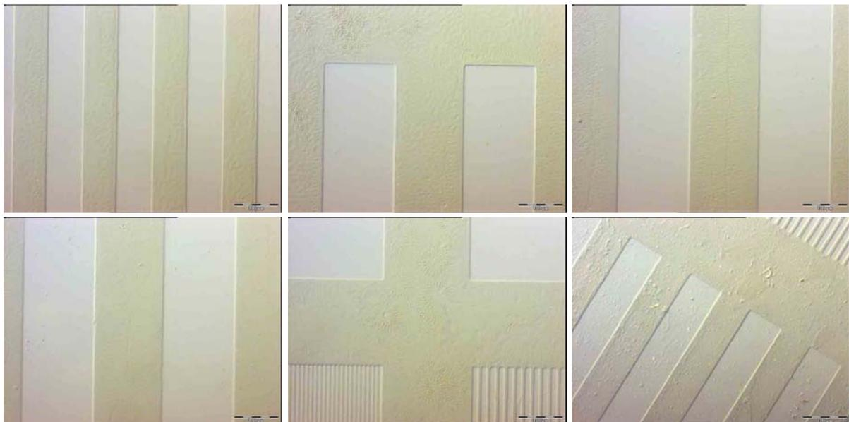
**Abbildung 101:** Lichtmikroskopische Aufnahmen einer mikrostrukturierten PMAA/CdS-Probe.
