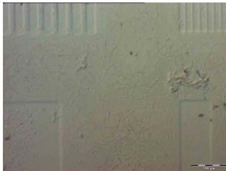
**Abbildung 123:** Lichtmikroskopische Aufnahme einer mikrostrukturierten, mit 1 mol% Cu-dotierten Zinksulfidpolymerbürste.
