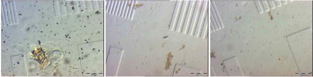
**Abbildung 152:** Lichtmikroskopische Aufnahmen mikrostrukturierter PMAA-Substrate zur Herstellung von PMAA/ $\text{Fe}_x\text{O}_y$ -Substraten (Bedingungen:  $1.9 \times 10^{-5}$  M  $\text{FeSO}_4$ - und  $2.1 \times 10^{-5}$  M  $\text{Fe}_2(\text{SO}_4)_3$ -Lösung (Verhältnis 1:1) für 12 h).
