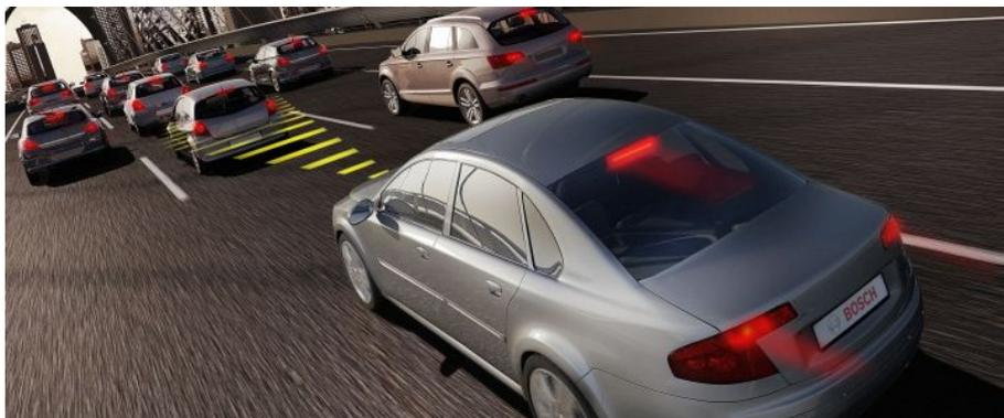
**Abbildung 1:** Vorausschauende Fahrerassistenzsysteme in Aktion: In dieser unerwarteten Stausituation können durch die Umfeldsensorik verschiedene Funktionen ausgeübt werden, zum Beispiel eine Alarmierung und Bremsunterstützung des Fahrers (*Predictive Emergency Braking Systems*) oder automatische Geschwindigkeitskontrolle (*Adaptive Cruise Control*).
