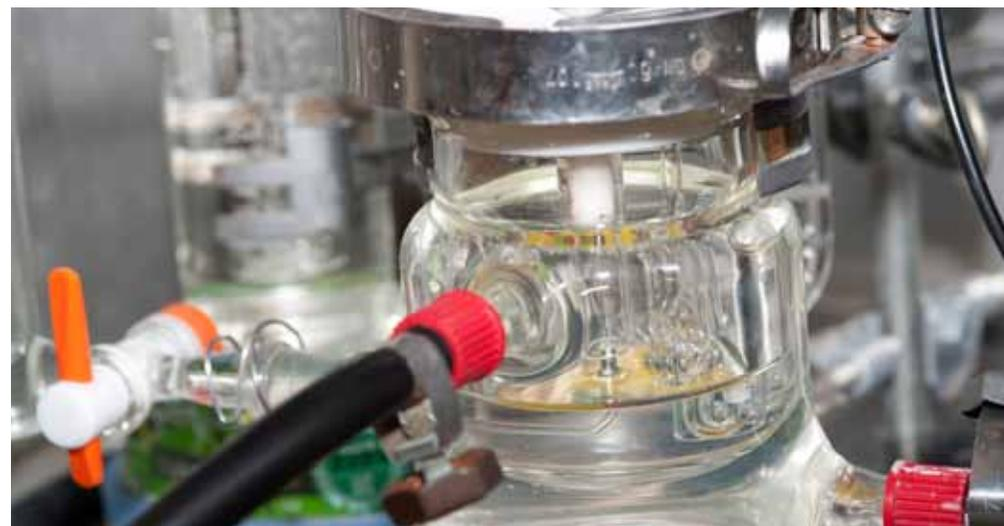
Eine thermostatisierbare Glaszelle zur elektrochemischen Untersuchung der Grenzfläche zwischen Einkristallelektrode und wässrigem Elektrolyt
