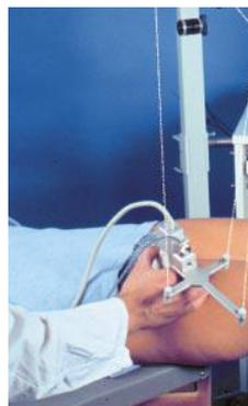
*Abb. 42: Patientenlagerung und Anordnung des Messsystems. Der mobile Teil des Ultraschallortungssystems ist am Schallkopf des Ultraschallgerätes (in der Hand des Untersuchers) und der andere Teil (Referenz) mittels Band am Unterschenkel des Patienten befestigt [77].*
