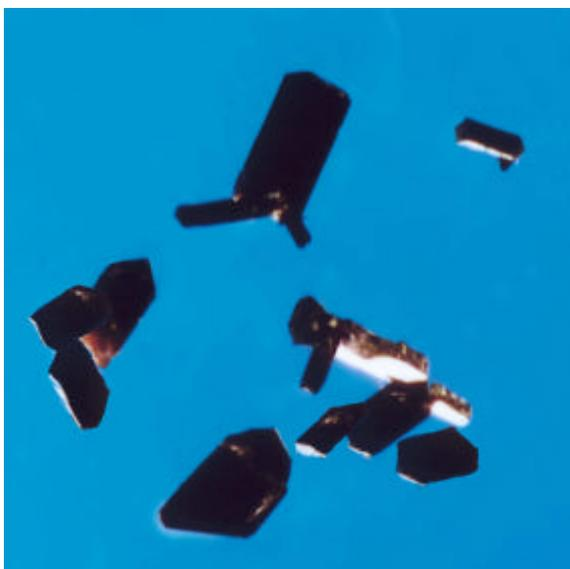
**Abb. 5-11:** Durch Chemischen Transport dargestelltes  $V_3GeO_7$ .
