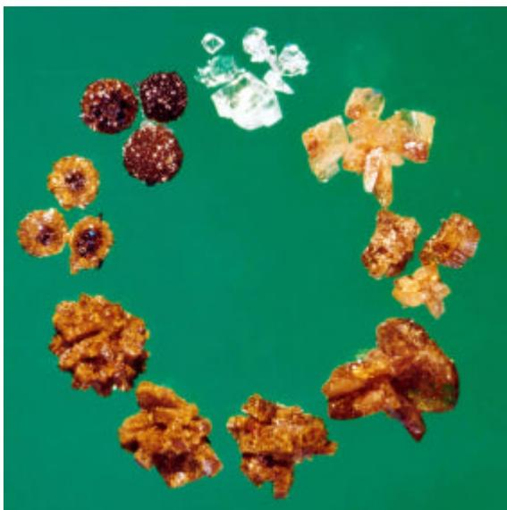
**Abb. 7-5:** Durch Chemischen Transport dargestelltes  $(Fe, In)_2Ge_2O_7$ .
