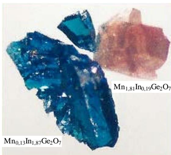
**Abb. 7-3:** Durch Chemischen Transport dargestelltes  $(Mn, In)_2Ge_2O_7$ .
