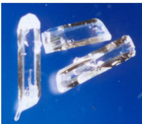
**Abb. 5-10:** Durch Chemischen Transport dargestelltes Zinkgermanat ( $\text{Zn}_2\text{GeO}_4$ ).
