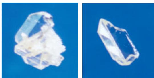
Abb. 5-13: Durch Chemischen Transport dargestelltes  $\text{In}_2\text{Ge}_2\text{O}_7$ .
