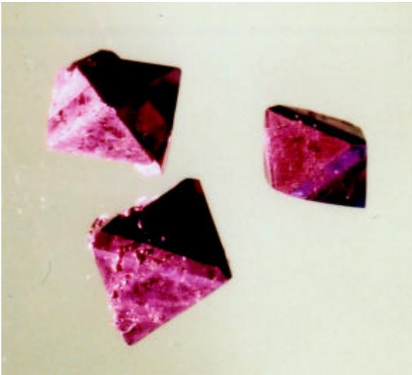
Abb. 6-8: Durch Chemischen Transport dargestelltes  $(Ni, Co)_2GeO_4$ .
