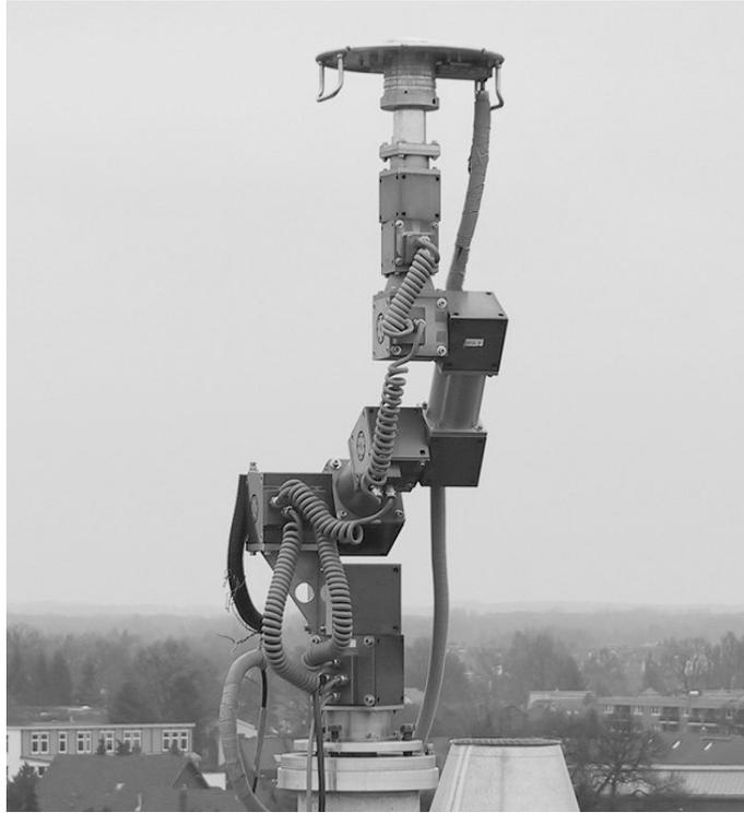
Abbildung 6.9: Roboterarm zur Absoluten Antennen- und Stationskalibrierung.
