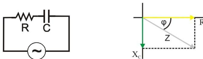
**Abbildung 2.4:** links: RC-Kreis aus Reihenschaltung von Wechselspannungsquelle, Widerstand  $R$  und Kondensator  $C$ . rechts: Zeigerdiagramm zur Verdeutlichung des Zusammenhangs zwischen reellem Widerstand  $R$ , der Kapazität  $X_c$  und  $Z$  als Vektorsumme aus beiden Größen.
