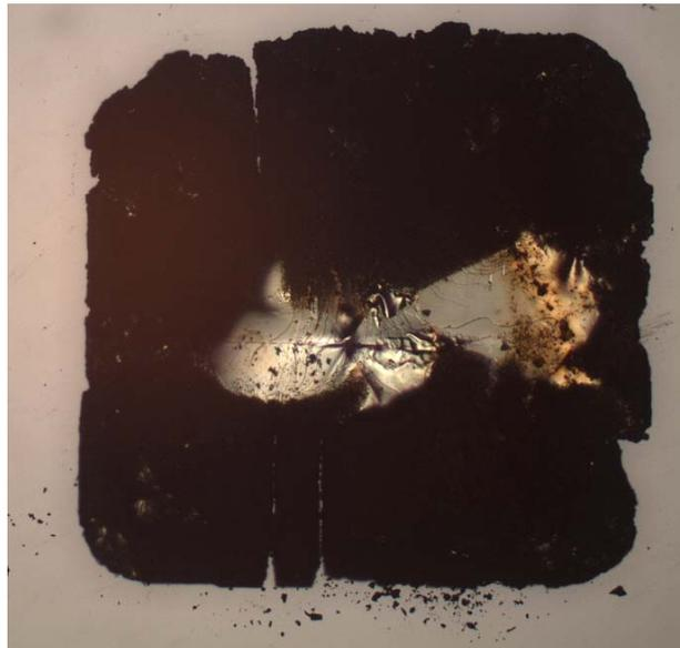
**Abbildung 6.28:** TiTe<sub>2</sub>-Einkristall, der acht Tage lang bei Raumtemperatur der BuLi-Lösung mit einer Konzentration von  $1,6 \text{ mol}\cdot\text{L}^{-1}$  ausgesetzt war. Die Oberfläche ist in der Mitte intakt, die Kanten sind korrodiert, sie zerfallen. Die Kantenlänge des Vierecks beträgt 2 mm (Probe 1,6TITE8d).
