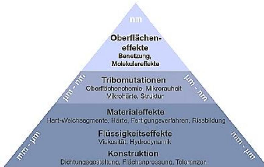
**Abb. 4.7** Einflussfaktoren für ein tribologisches System, das aus Dichtung, Gegenlauffläche und Schmierstoff besteht [182]
