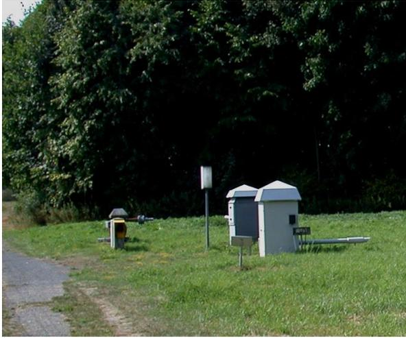
Abbildung 51: High volume sampler der PTB [77]
