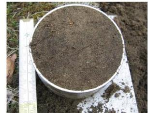
Abbildung 23: Stechzylinder zur Bestimmung der Lagerungsdichte
