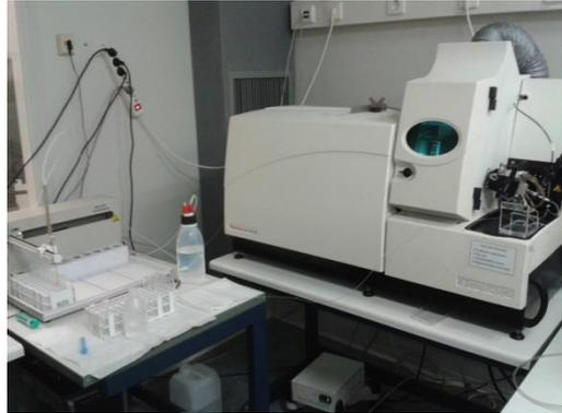
Abbildung 24: ICP-MS mit Autosampler
