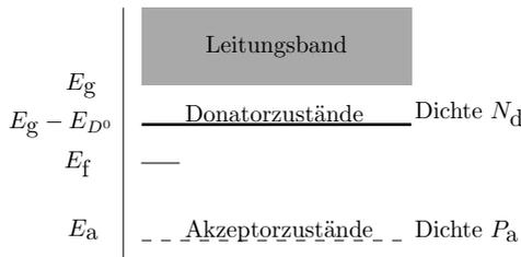
**Abbildung 2.4:** Modell eines teilweise kompensierten Halbleiters. Donatordichte  $N_d$  und ungewollte Akzeptordichte  $P_a$  befinden sich jeweils in der Bandlücke mit Energie  $E_g$  bei  $E_g - E_{D^0}$  und  $E_a$  und bestimmen die Lage der Fermi-Energie  $E_f$ .
