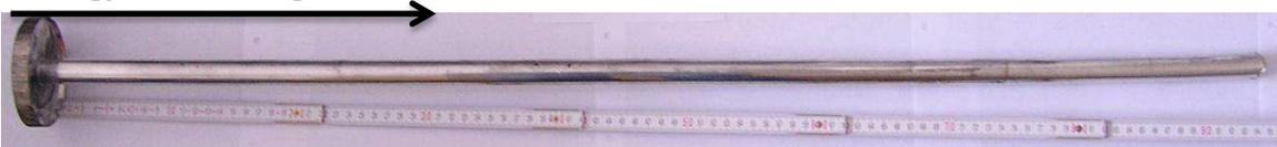
Bild 4.4.6. Stange aus Al-3%BN(5) nach dem Strangpressen bei 350°C
