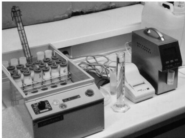
**Abbildung 22:** Beispiel für ein On-Farm-Milchanalysegerät auf Ultraschallbasis
