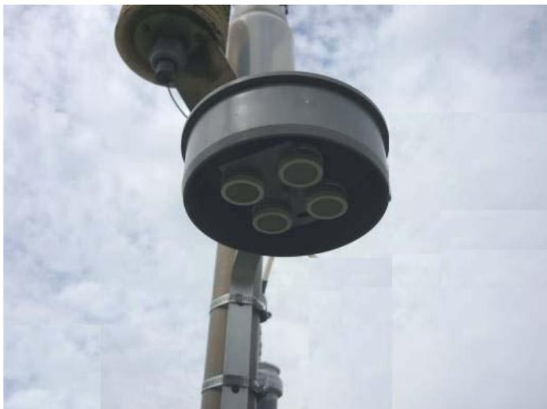
**Abbildung 4.4:** Messmast mit Passivsammlern vom Typ IVL.
