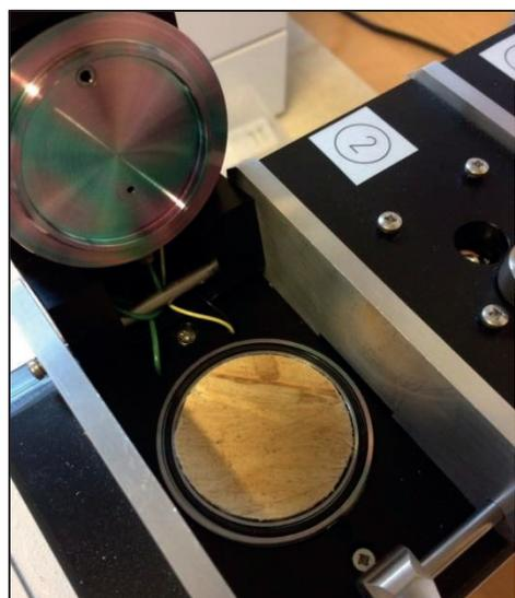
Abbildung 2: geöffnete Prüfkammer der Micro-Chamber mit OSB-Probe
