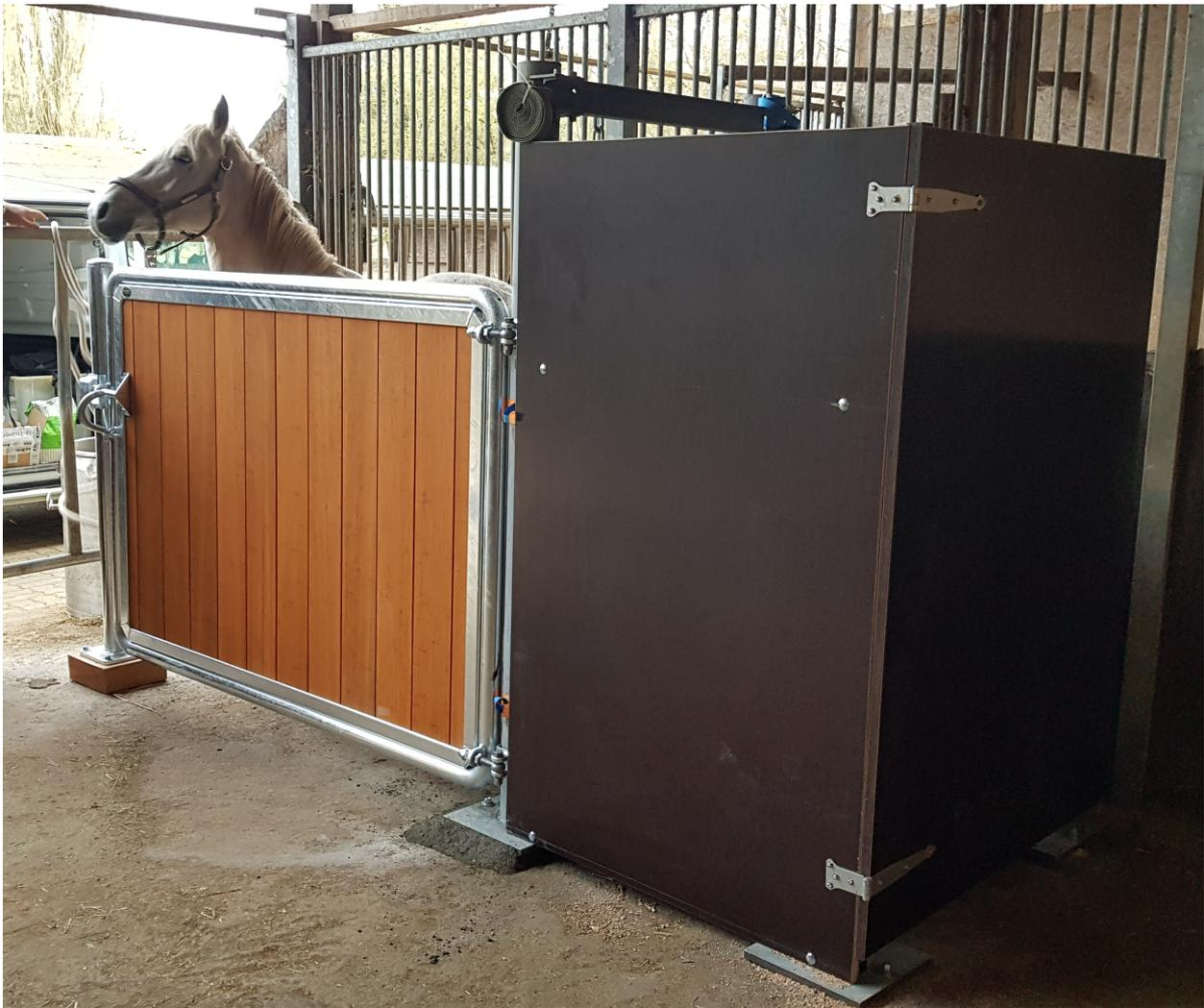
**Abbildung 3:**    Probiertstand mit Möglichkeit zur Bestimmung der beim Auskeilen wirksam werdenden Energie (Foto: Benthien).
