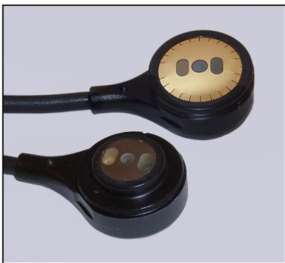
Abb. 3: Tosca<sup>®</sup>-Sensor mit (oben) und ohne Bespannung (unten)
