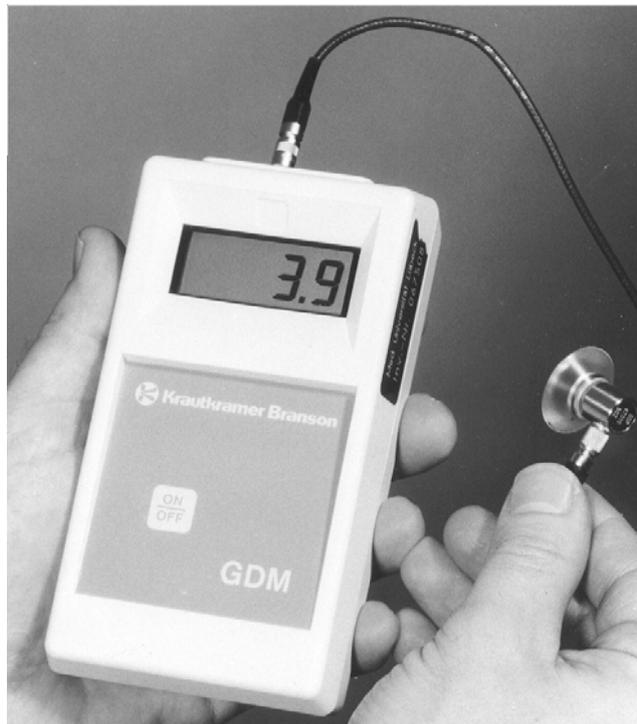
**Abb.1 Gewebedickenmessgerät der Firma Krautkrämer**
