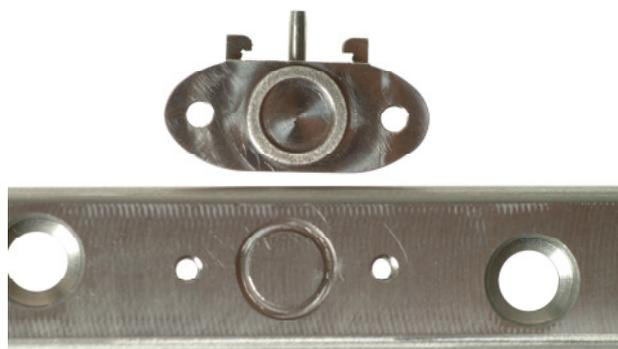
Abb. 44: siehe Abb. 42, jedoch mit kreisförmiger Nut-Feder-Verbindung zentrisch angeordnet
