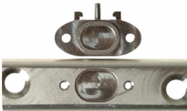
*Abb. 46: Mittleres Osteosyntheseplattensegment (unten), vorbereitet zur Aufnahme eines Sensorgehäuses (oben). Verbindung beider Teile mit ovaler Taschen-Feder Verbindung und Montageschrauben*
