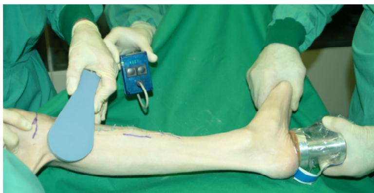
Abb. 71: Krafteinleitung über Messdose im Fersenbereich, Signalabnahme über Datenlogger
