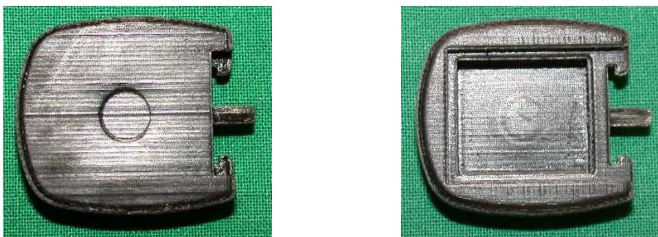
Abb. 92: Äußere Ansicht (li.) und innere Ansicht (re.) des Gehäuses der Sende/Empfangseinheit mit Druckstellen des Prüfstempels nach Drucktest.
