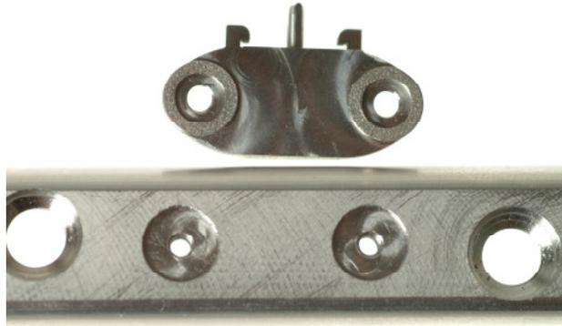
*Abb. 45: siehe Abb. 42, hier jedoch mit kreisförmiger Nut-Feder-Verbindung um die Plattenlöcher der Montageschrauben herum*
