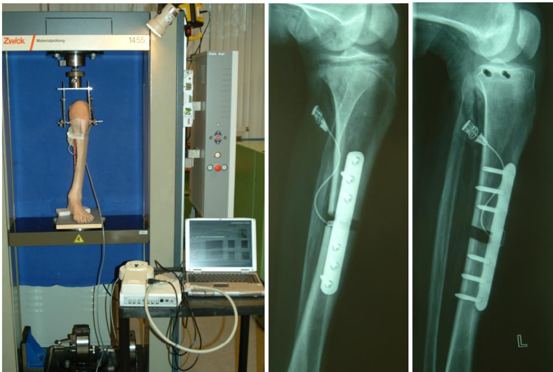
*Abb. 73: Prüfsituation in Zwick-Maschine (li.), Röntgenbild in zwei Ebenen (re.), deutliche Darstellung der Kabelverbindung und der Lese-/Sendeeinheit*
