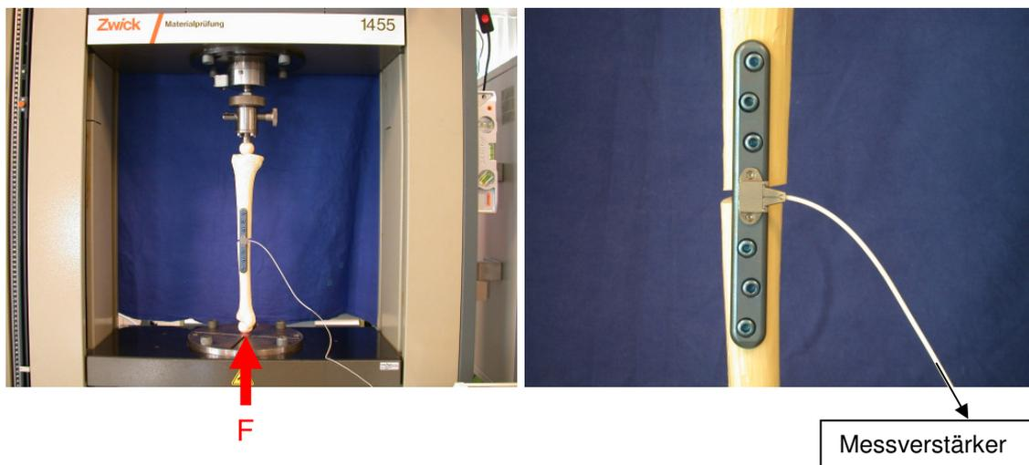
Abb. 50: Tibia-Implantat mit montierter Sensoreinheit. Kabel mündet in einem Messverstärker zur Funktionsüberprüfung.
