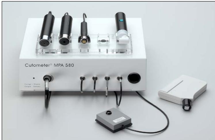
**Abbildung 4: Cutometer MPA 580® mit den Zusatzsonden Mexameter® MX 18, Corneometer® CM 825 und Tewameter® TM300 (Quelle: [www.courage-khazaka.de](http://www.courage-khazaka.de)<sup>[15]</sup>)**
