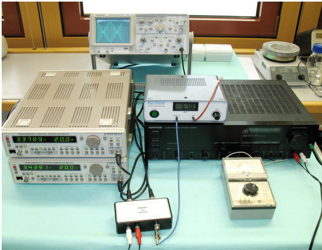
Abb. 2, Geräteaufbau zur Erzeugung von schwebenden Magnetwellen
