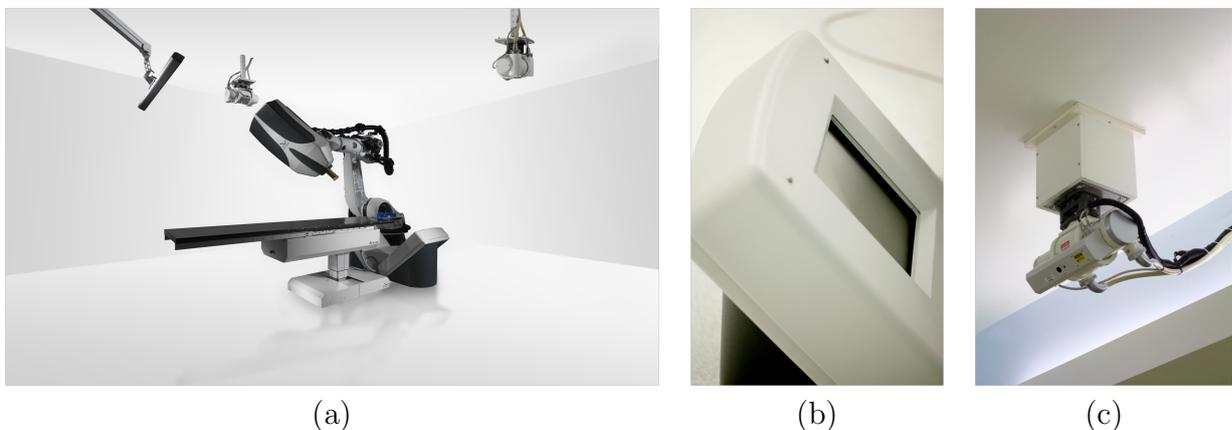
Abbildung 7.1: Übersicht eines CyberKnife®-Systems (Accuray Inc., USA, California) (a). Wichtigste Hardware-Systemkomponenten: Ein an einem 6-achsigen Roboterarm befestigter 6MV-Linearbeschleuniger, eine IR-Stereokamera, eine bewegliche Patientencouch, zwei Röntgenquellen (c) mit orthogonal angeordneten Detektoren (b). Quelle: Accuray Inc.
