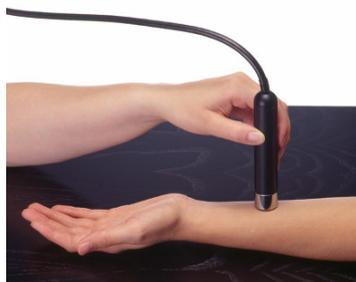
**Abbildung 17** Cutometer MPA 580® der Firma Courage+Khazaka electronic
