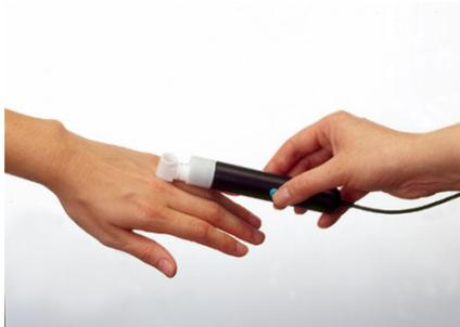
**Abbildung 21 Tewameter® (Messung auf der Haut)**
