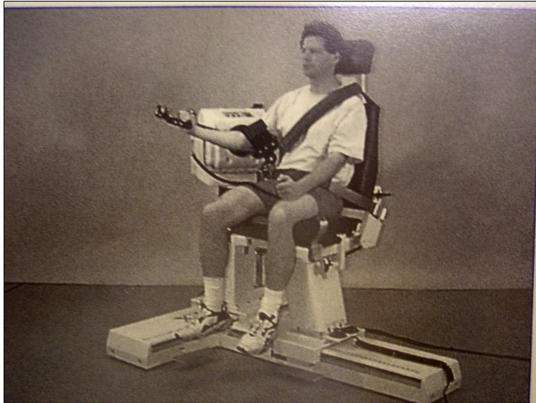
Abb.11 Biodex System 3 © - Testaufbau zur isokinetischen Kraftmessung
