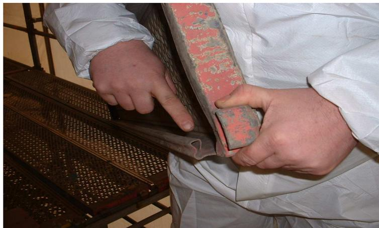
Abbildung 5: Staubrückstände in einem Trittbrett
