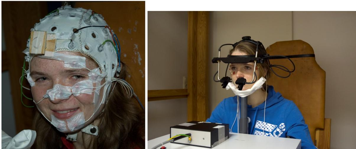
**Abbildung 6: Proband kurz vor dem Versuchsstart; links: Messung mit Search Coil und EOG; rechts: Mit Videokulographie und EOG**
